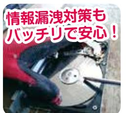
また、情報漏洩対策として出張解体を行っています。その場でハードディスクを抜き出し、傷付けを行います。出張解体もぜひお任せください。
